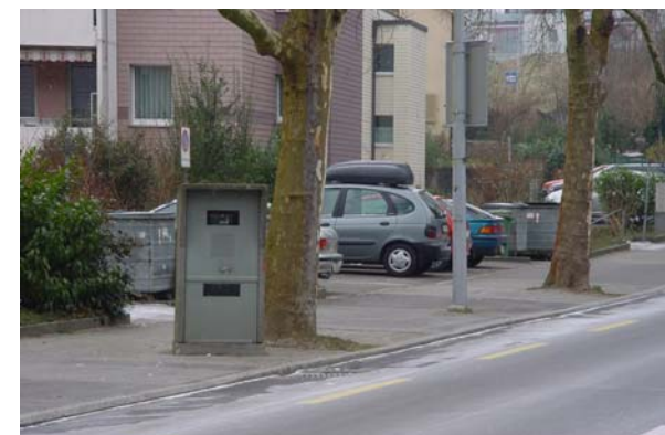
Abb. 20.16 Automatische Geschwindigkeitsüberwachung, Wohnquartier Langensand, Stadt Luzern
